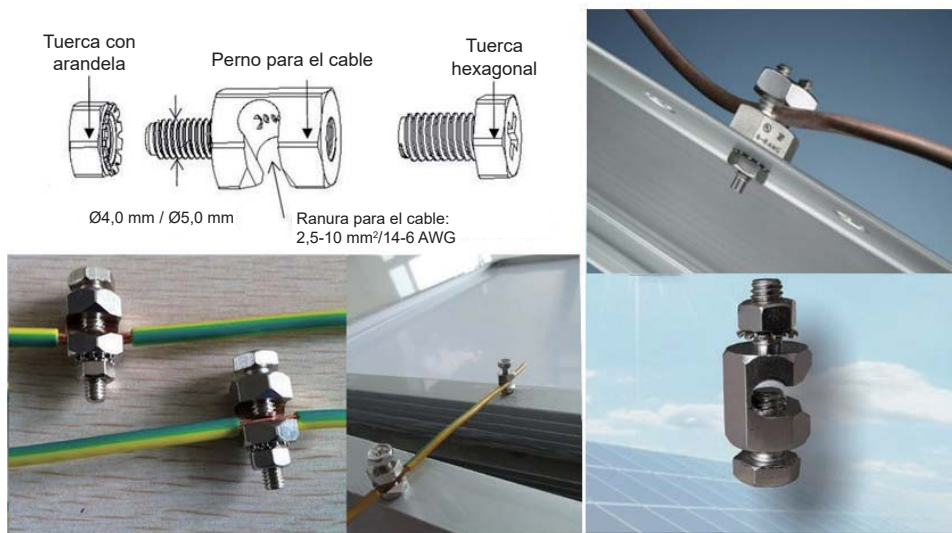
Figura 5: Métodos de instalación
