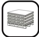
El paletizado o apilado del producto debe realizarse sin rozar las piezas entre sí y evitando el atrapamiento de partículas de cualquier tipo entre las mismas.
