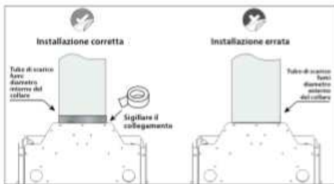
Figura 11 - Assemblaggio del condotto di scarico all'apparecchio
