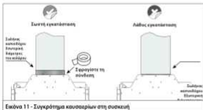
Εικόνα 11 - Συγκρότημα καυσαερίων στη συσκευή
