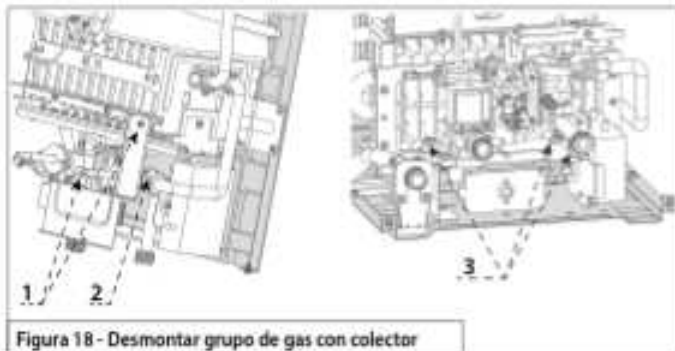
Figura 18 - Desmontar grupo de gas con colector
