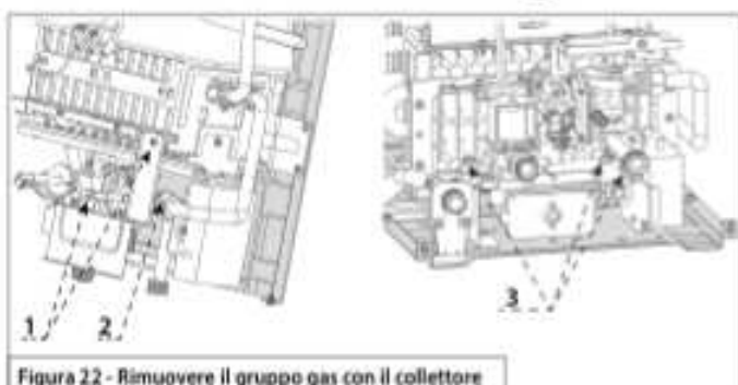
Figura 22 - Rimuovere il gruppo gas con il collettore
