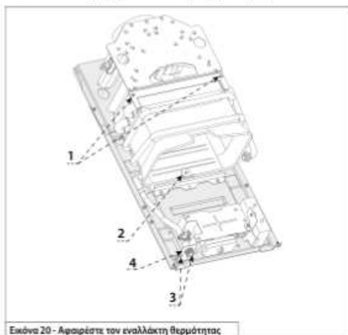
Εικόνα 20 - Αφαιρέστε τον εναλλάκτη θερμότητας
