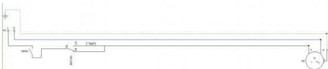
Figura 1. Esquema eléctrico del ventilador del insertable
