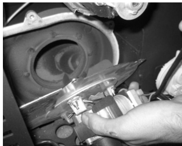
Figura 61 – a) Retirar los tornillos; b) Retirar el extractor
