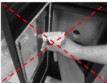
Figura 62 – Limpieza incorrecta del vidrio
