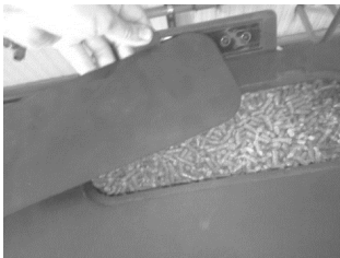
Figura 53 – Reabastecimiento del depósito de pellets
