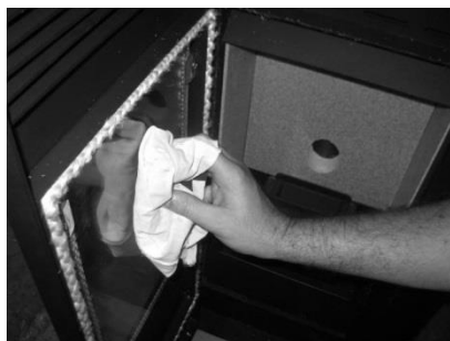
Figura 63 – Limpieza del vidrio: a) Aplicar líquido en el paño; b) Limpiar el vidrio con el paño
