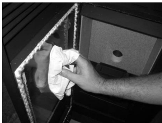
Figura 57 – Limpieza del vidrio: Limpiar el vidrio con el paño
