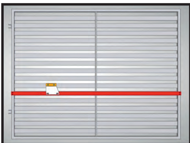
Widok poprawnie skręconego mocowania od strony posesji
