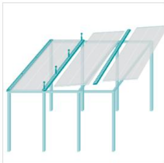
12 | Type d'installation avec des montants verticaux
