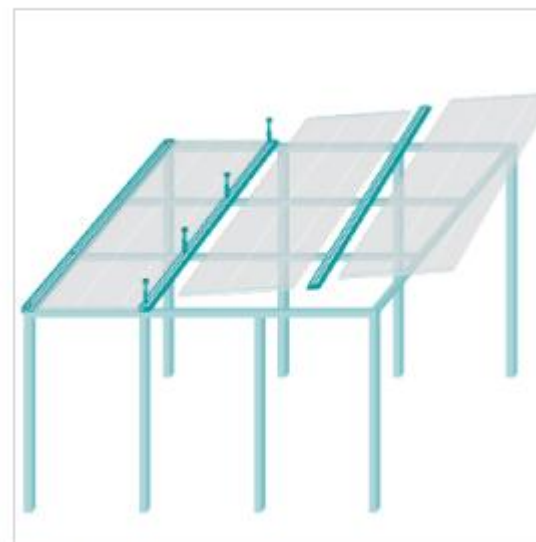
13 | Type d'installation avec des montants horizontaux
