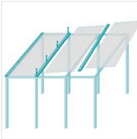
13 | Type d'installation avec des montants verticaux
