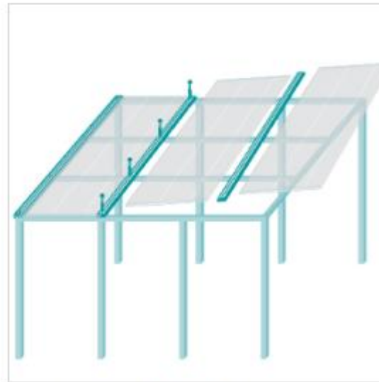
14 | Type d'installation avec des montants horizontaux
