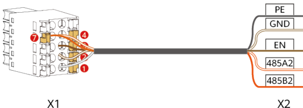
Figura 6-2 Cable de señal (se compra al proveedor, tipo 1) entre la batería y el inversor
