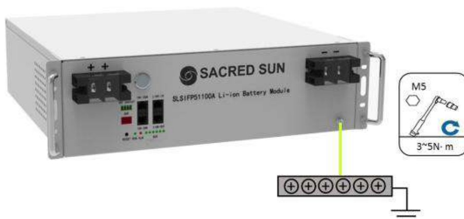
Figura 5-1: Instalar el cable de puesta a tierra
