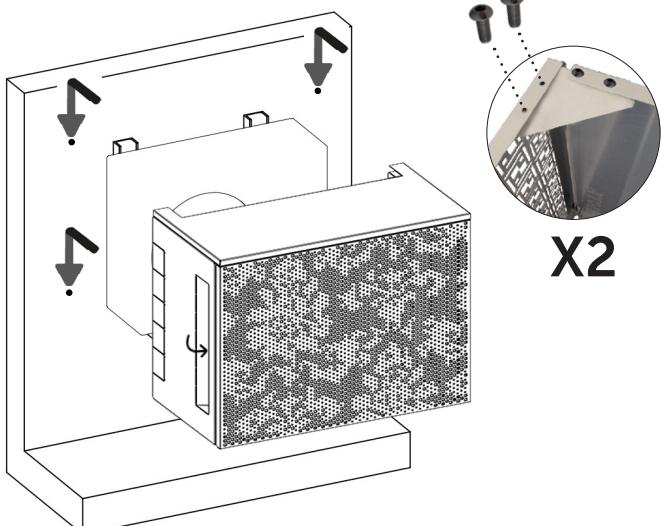
**!** No olvides apretar las fijaciones de la pared una vez colocado el revestimiento y plegar las solapas sobre la ventilación.
