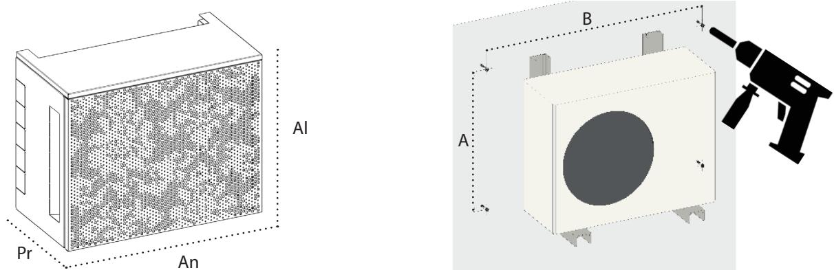
**Consejo :** Si necesita pasar tuberías o fuentes de alimentación por el lateral, selecciona las zonas precortadas adecuadas en los paneles laterales.
