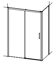
**A** Ajustar el descuadre del vidrio lateral y fijar la posición atornillándolo como se muestra
