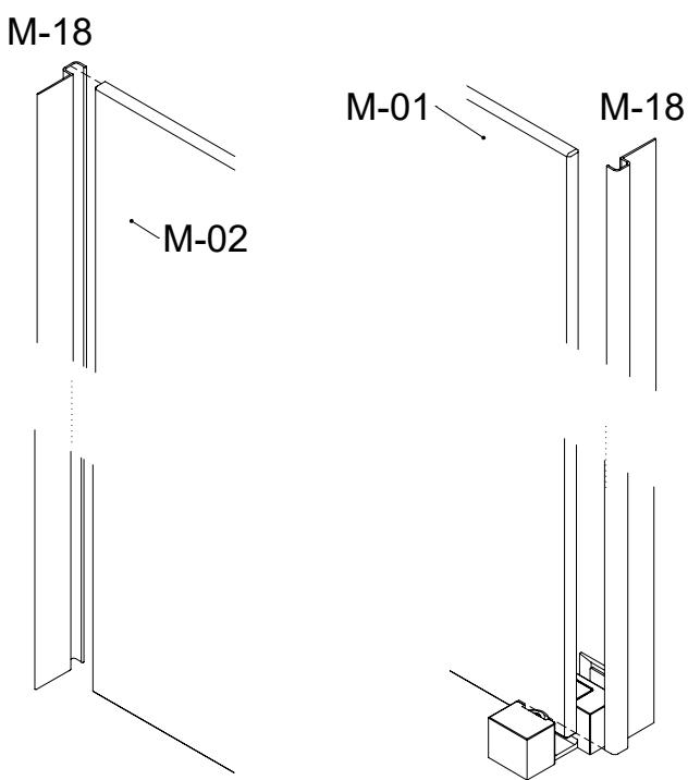
**C** Cortar y colocar vierteaguas inferior en la hoja corredera y añadir los soportes de ayuda de apoyo del vidrio
