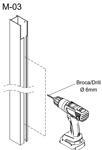
**B** Marcar los taladros del marco fijo y el exterior del perfil en la pared
