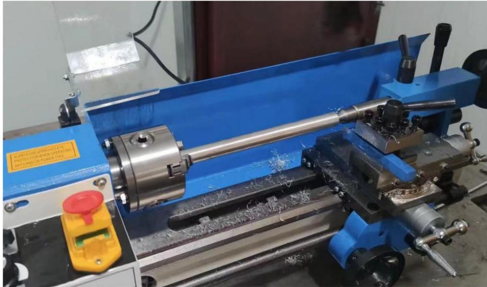
Fig 6 Maintien et perçage de la pièce
