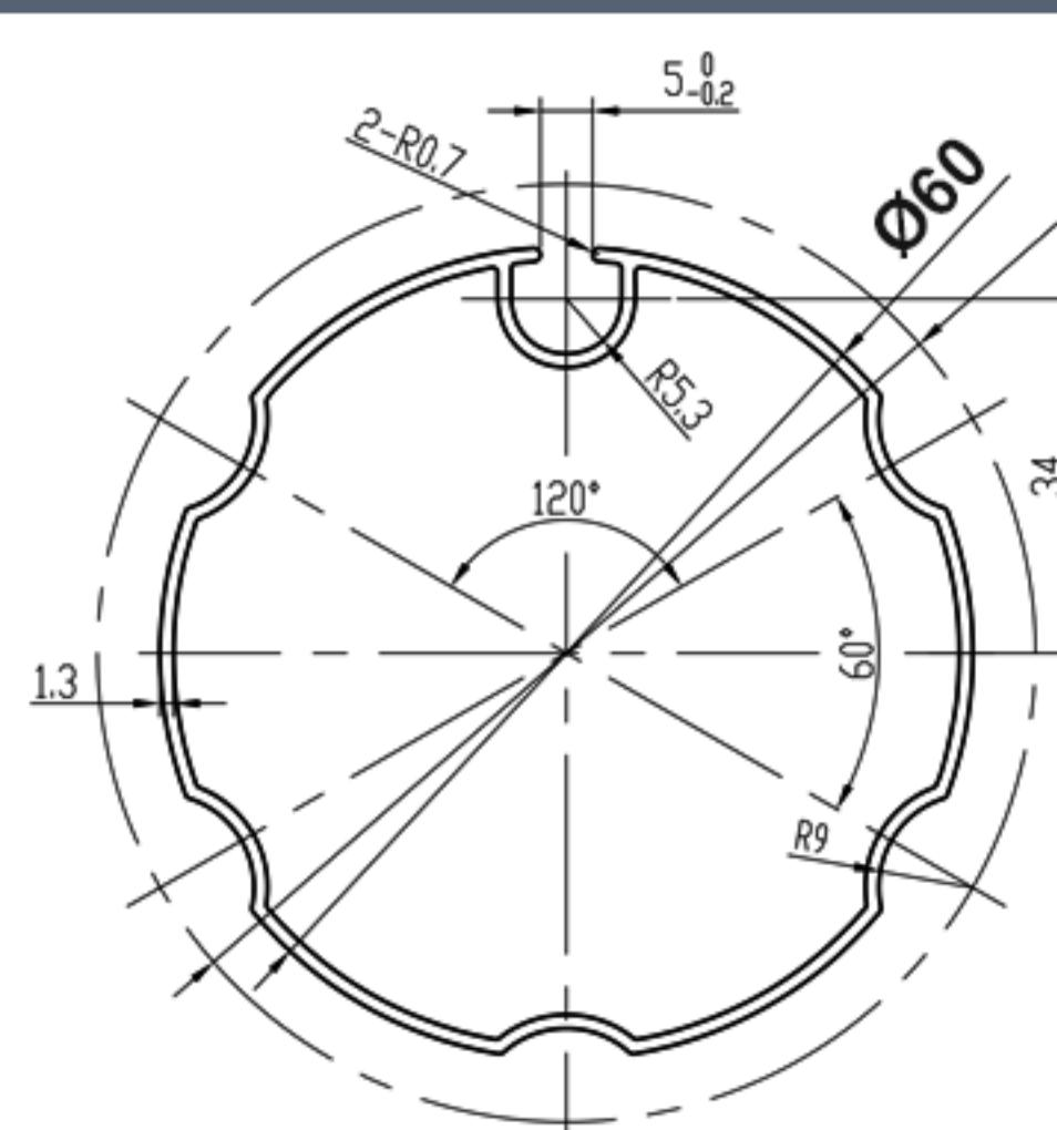
**Remarque :** tube d'enroulement de 60 mm de diamètre. Fabriqué en 100% aluminium extrudé (non en acier).
