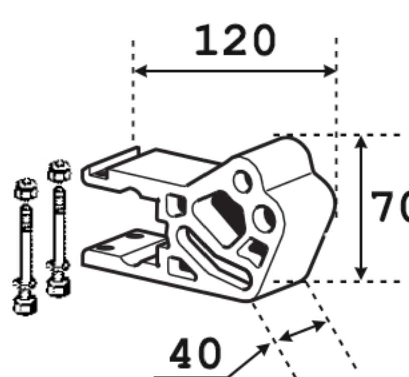
**Remarque :** Support de bras renforcé. Fabriqué en 100% aluminium extrudé (non en acier classique).
