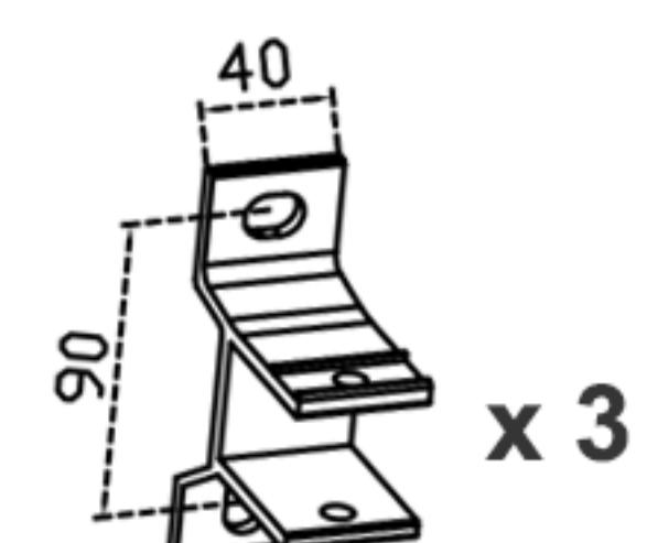
ATTENTION !!! Les entraxes entre les supports indiqués ci-dessus sont des données indicatives. Les supports muraux doivent être installés au niveau des supports des bras du store. Ces valeurs peuvent différer d'un store à l'autre lors de sa fabrication, car nous devons régler la position des supports des bras afin de trouver l'équilibre parfait du store.
