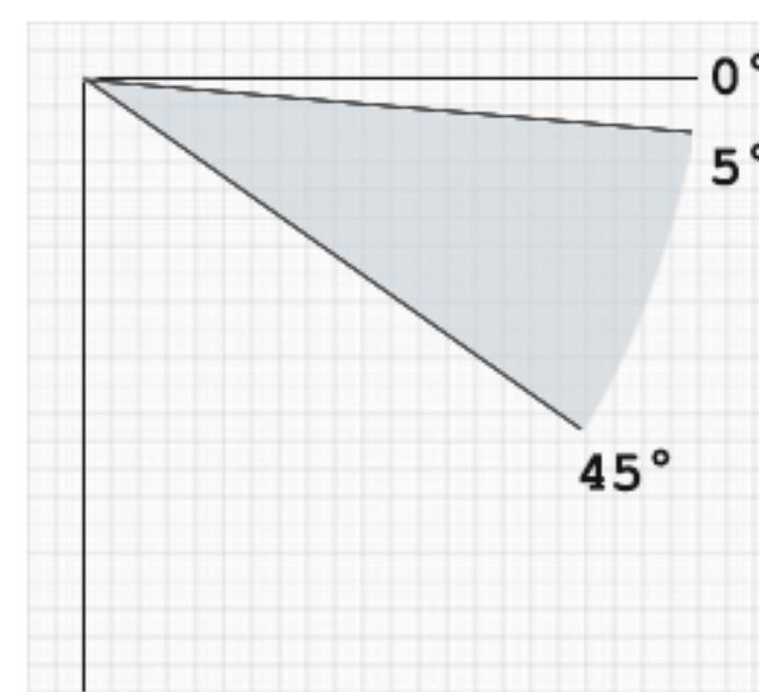
**Remarque :** Au moment de la pose, le store doit être réglé avec une inclinaison minimum de 5°. Nous recommandons de garder un angle compris entre 10° à 30° d'inclinaison.
