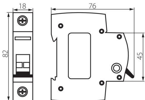
L'interrupteur-sectionneur est utilisé pour déconnecter les circuits chargés de courant nominal.
