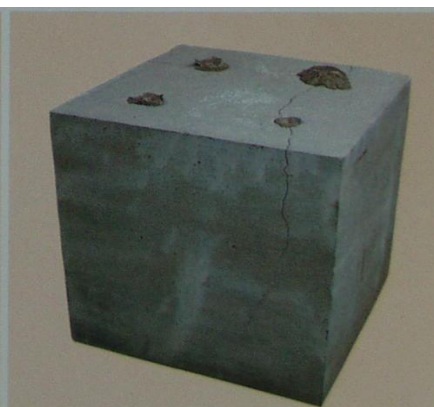
Premières fissures après 4 heures
