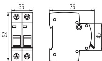
Le disjoncteur avec protection contre les surintensités est utilisé pour la protection des câbles contre les surcharges et les courts-circuits dans les installations et les appareils.
