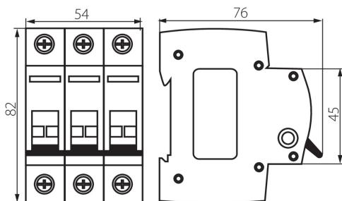
L'interrupteur-sectionneur est utilisé pour déconnecter les circuits chargés de courant nominal.
