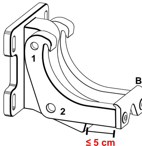
**ASTUCES !!!** Veuillez mesurer la distance entre la partie centrale mobile et la plaque de sécurité [B] (voir schéma).
