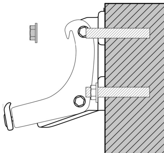
**REMARQUE !!!** Ne pas laisser la tige filetée dépasser de plus de 2 mm derrière l'écrou. Dans le cas de scellements chimiques, laisser prendre la résine le temps indiqué sur la cartouche et fixer les supports en approchant les écrous à la main
