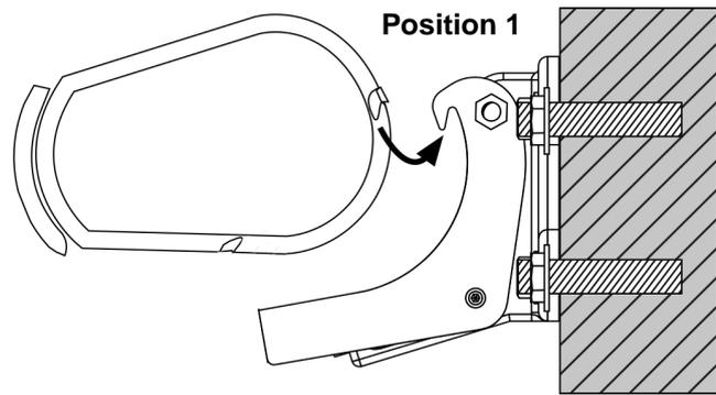
**REMARQUE !!!** Au cas où la plaque de sécurité [B] ne pourrait pas s'insérer facilement dans la rainure du store ou si les deux trous de vis ne sont pas correctement alignés avec le support mural :
