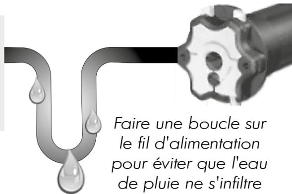
*Faire une boucle sur le fil d'alimentation pour éviter que l'eau de pluie ne s'infilte dans la tête moteur.*
