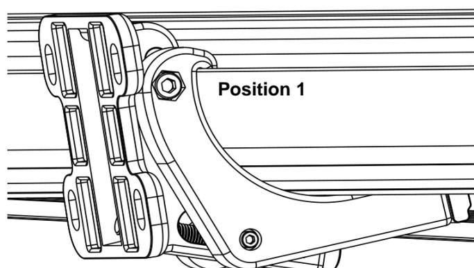
Puis, refixez la plaque de sécurité [B] sur les supports muraux. Il faut s'assurer de maintenir le store en place avant que les plaques de sécurité ne soient complètement fixées. Les plaques de sécurité [B] doivent s'accrocher et être correctement insérées dans la rainure inférieure [position 2] du store.
