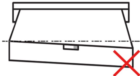
**REMARQUE !!!** Il faut s'assurer que la barre de charge est bien à niveau lorsque le store est entièrement déployé. Toutefois, tous les supports n'ont pas l'obligation d'être exactement au même angle. Pendant le mouvement d'ouverture ou de fermeture, il est possible que le niveau de la barre de charge change, ce qui est tout à fait normal.
