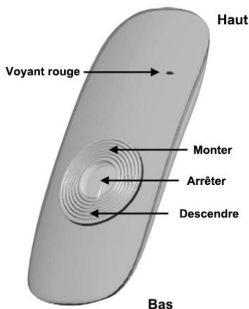
**ATTENTION !!!** Avant de procéder à la synchronisation de la télécommande, veuillez vérifier l'ordre de raccordement de tous les fils dans votre boîtier récepteur. Cet ordre varie en fonction du côté de la motorisation. Les directions 1 et 2 permettent de contrôler l'ouverture et la fermeture du store. Le bouton « Monter » de la télécommande doit rétracter le store, et le bouton « Descendre » doit déployer le store.
