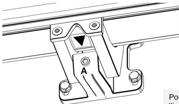
Pour niveler la barre de charge ou ajuster l'inclinaison du store, vous devez régler la vis vérin [A] située à l'avant des supports muraux.
