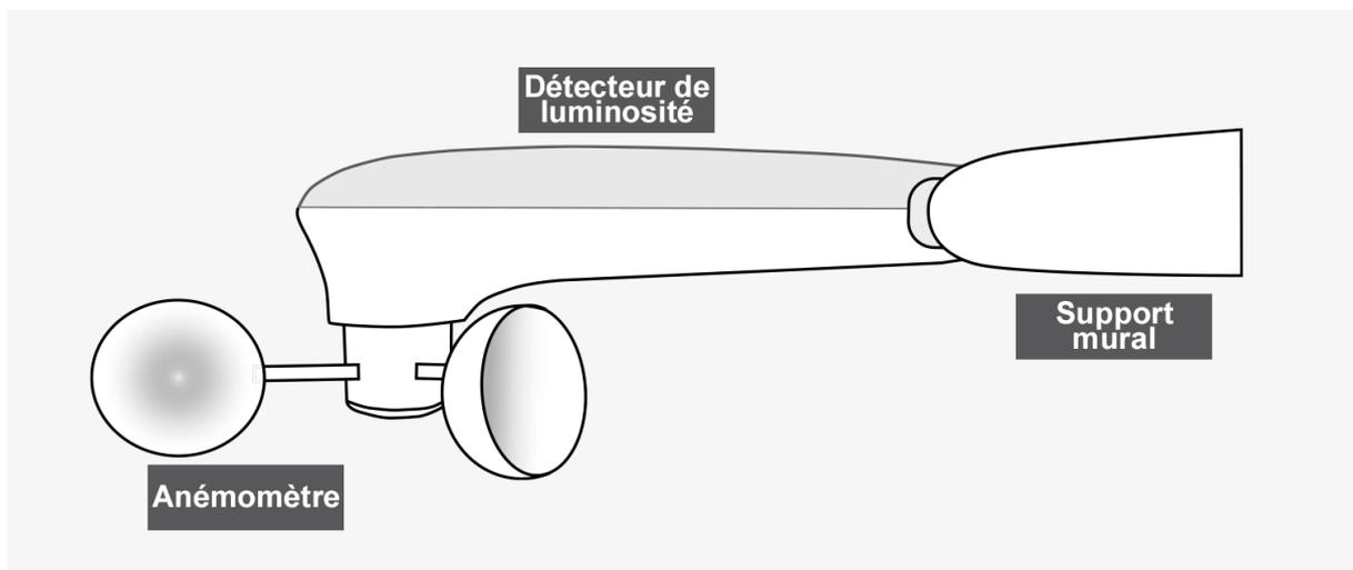
Le capteur vent et soleil se compose de l'anémomètre, du détecteur de luminosité et du support mural, qui peut être incliné de 90° vers le haut ou vers le bas.
