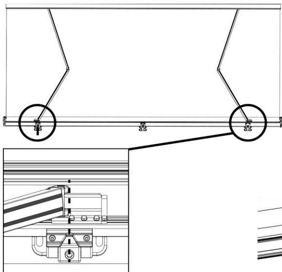
Il est essentiel de respecter ces positions indicatrices pour déterminer correctement l'emplacement des supports muraux. Lors de leur installation, **l'emplacement idéal est que les triangles rouges soient alignés avec les axes des supports muraux.**
