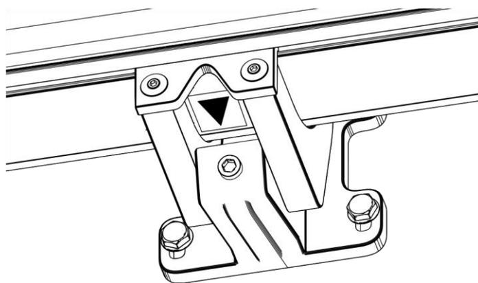
**ATTENTION !!!** Les supports muraux doivent être **placés sous et en alignement avec les supports de bras** pour garantir un équilibre optimal des forces.
