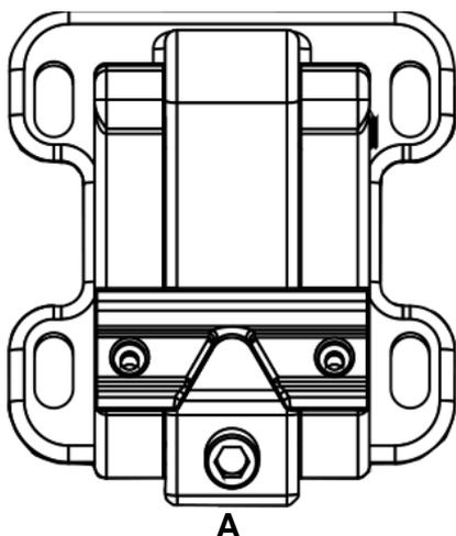
**REMARQUE !!!** Lors de l'ajustement, il est possible de desserrer légèrement les deux écrous sur le côté des pattes du support mural, ce qui permet d'obtenir un ajustement plus précis de l'inclinaison, puis de resserrer ces deux écrous après l'ajustement.
