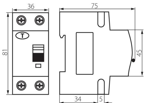
Le disjoncteur différentiel avec protection contre les surintensités est utilisé pour la protection contre les surcharges et les courts-circuits dans les installations et les appareils, ainsi que pour la protection contre les chocs électriques.
