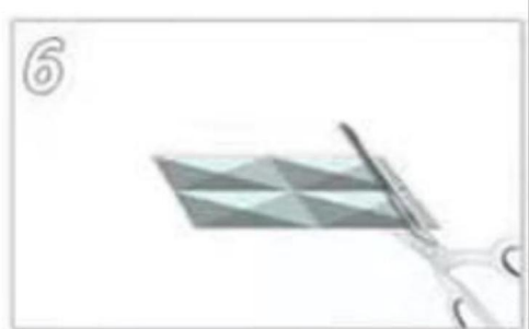
Fase 6: tagliare il pannello in base alle dimensioni angolo del muro.
