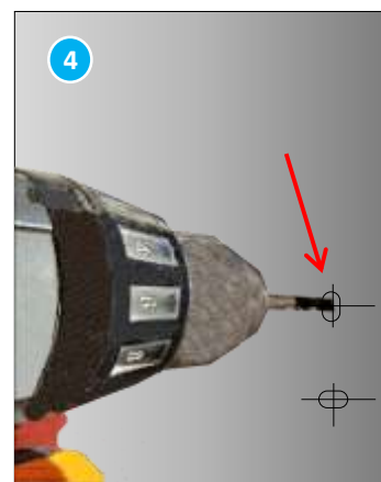
Pré-percez à l'aide d'un foret à bois ou foret béton suivant la nature du support.
