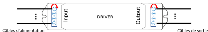
Figure 1 : Représentation schématique : Bornier à Vis
