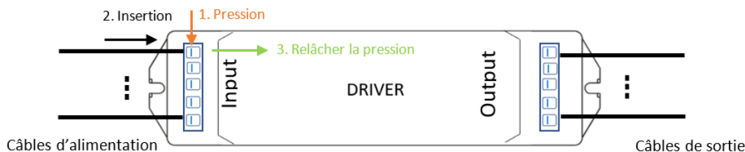
Figure 3 : Représentation schématique : Bornier à Pression
