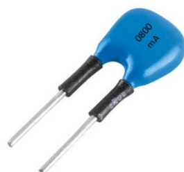
Résistance – Sortie 800 mA
