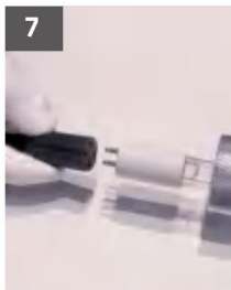
Anslut lampsockeln med uv-lampstiften ordentligt.
