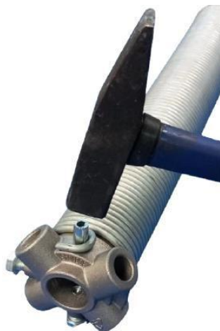
Positionnement de la goupille spiralée dans le crochet du ressort
