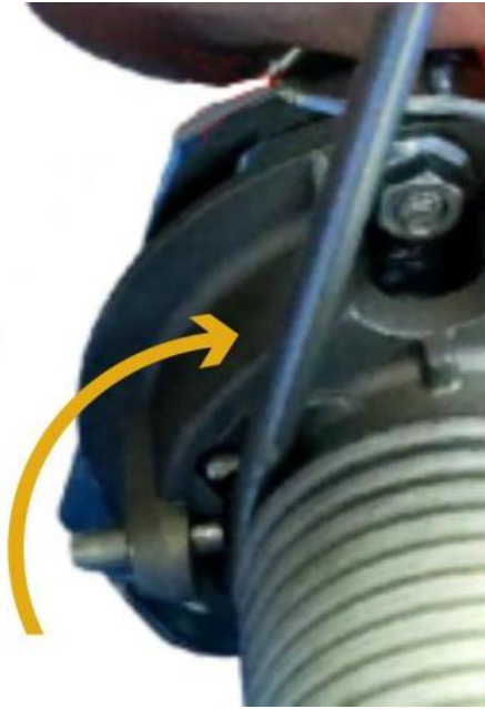
Extraction progressive de la goupille
