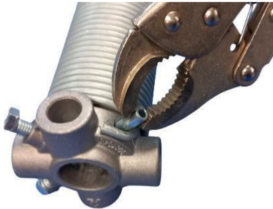
Retrait de la goupille spiralée côté mandrin / cône de serrage
